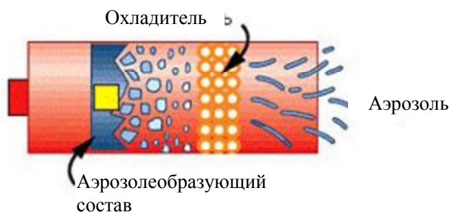
Рис. 7.5.2. Схема генерации аэрозоля
