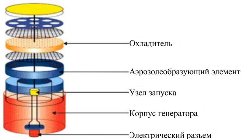
Рис. 7.5.1. Принципиальное устройство генератора огнетушащего аэрозоля
